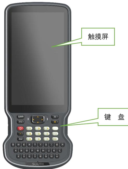
★触摸屏：电容屏，多点触控，湿手触控，支持主动电容笔，支持戴手套触控
